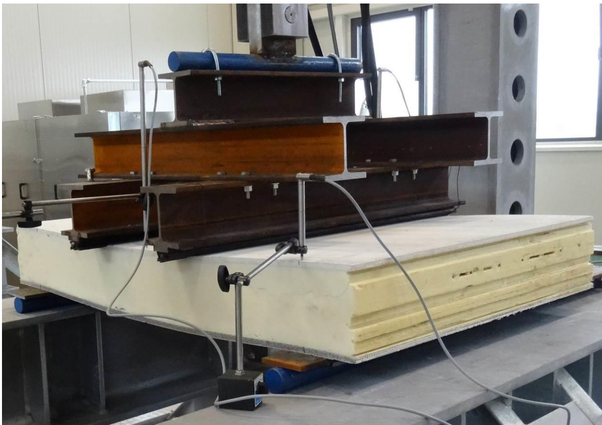
Obr. 6 Průhyb vzorku 1 před porušením.
