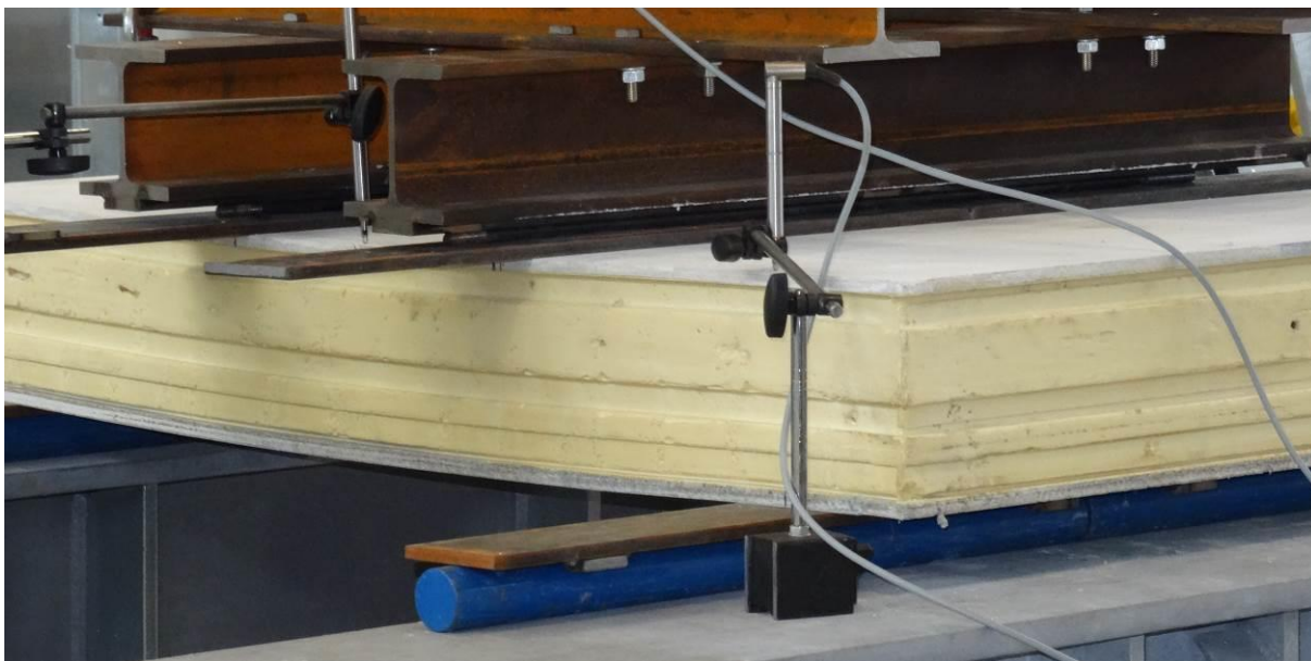
Obr. 16 Průhyb vzorku 3 před porušením.
