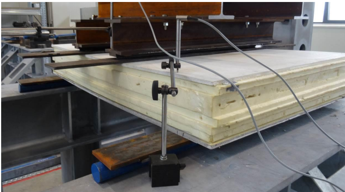
Obr. 11 Průhyb vzorku 2 před porušením.
