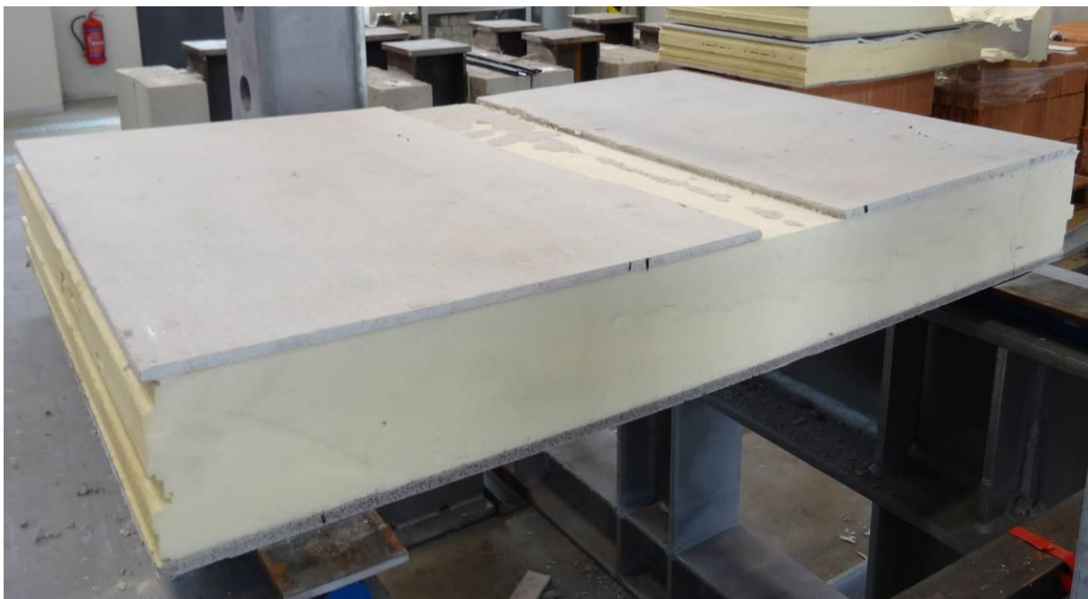
Obr. 18 Porušení horní desky fermacell vzorku 3.
