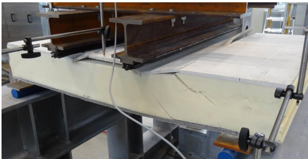
Obr. 8 Průběh smykových trhlin.
