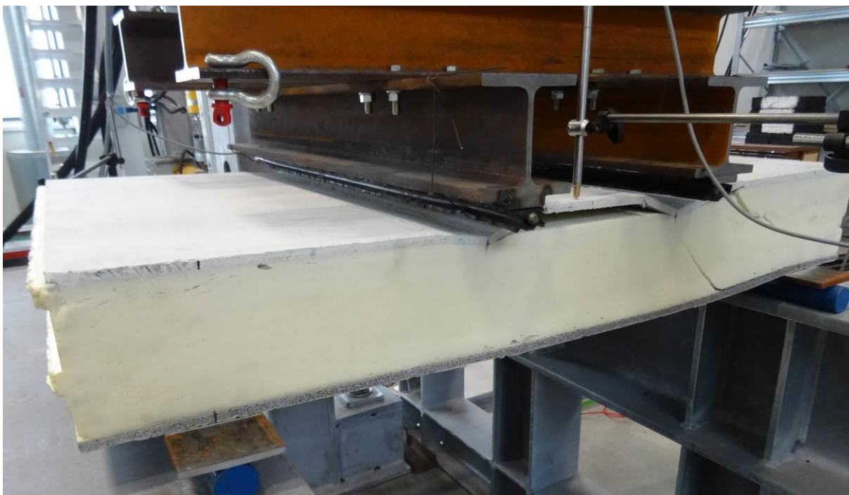
Obr. 7 Porušení protlačením v místě vnášení zatížení v kombinaci s porušením smykem.
