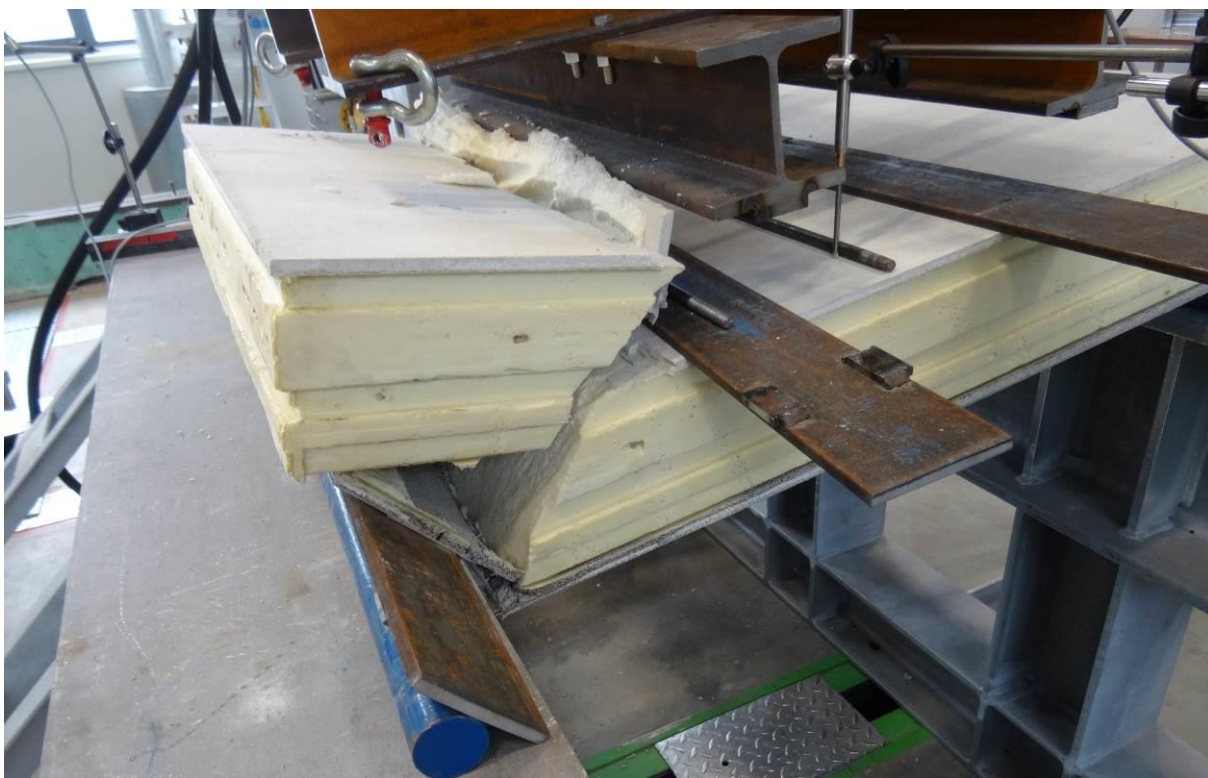
Obr. 12 Vzorek 2 po porušení.
