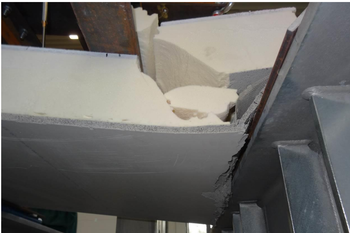
Obr. 13 Porušení smykem vzorku 2.
