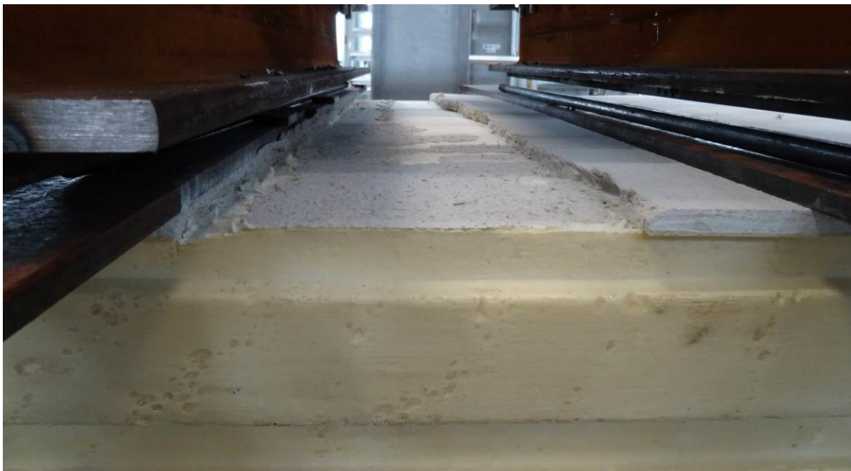
Obr. 17 Porušení horní desky fermacell vzorku 3 souběžně s hranou roznášecí ocelové desky.
