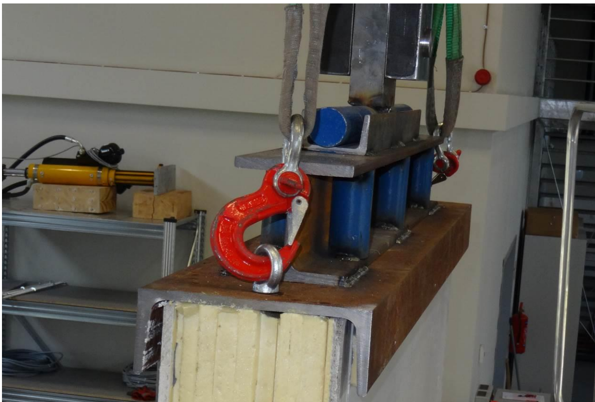
Obr. 3 Detail horního uložení.
