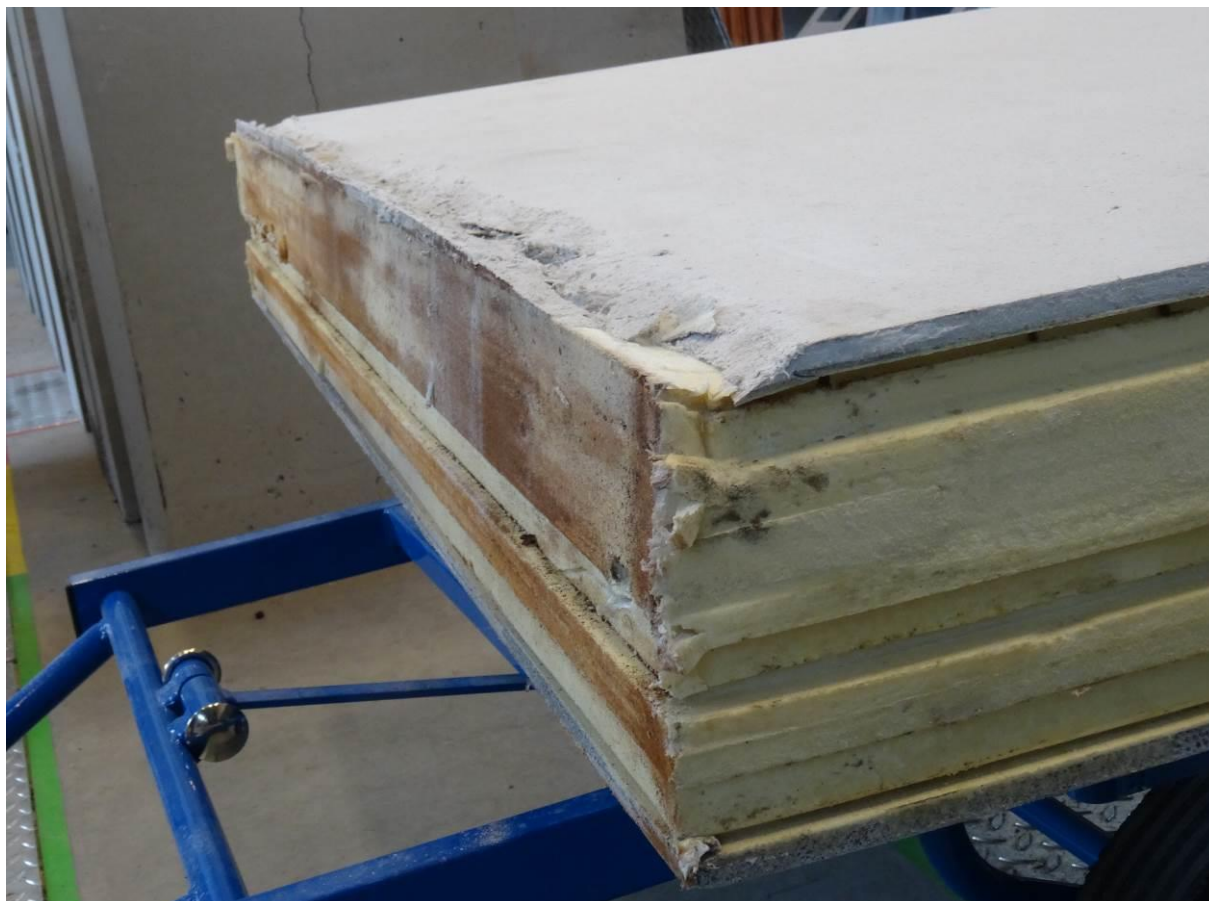
Obr. 10 Detail porušení smykem vzorku 1 po vyjmutí ze zatěžovacího zařízení.
