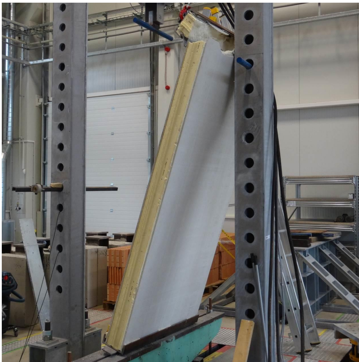
Obr. 25 Porušení v horní části vzorku 4.
