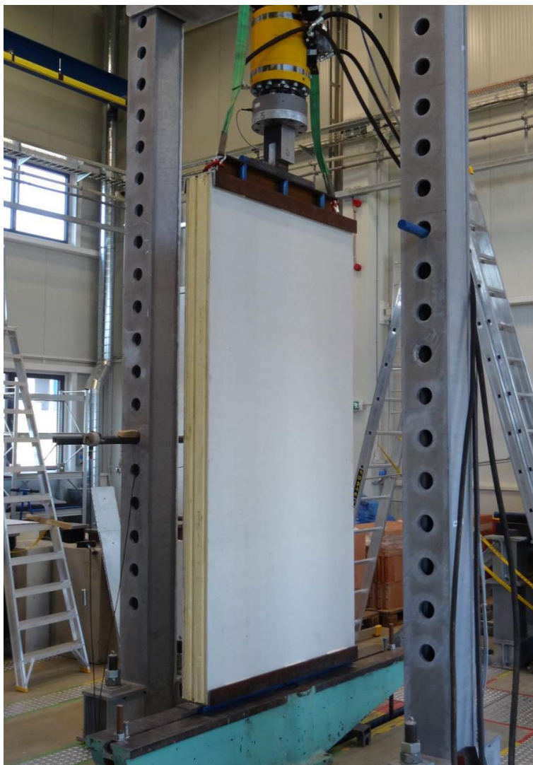
Obr. 2 Sendvičový panel připravený k testu na osový tlak.
