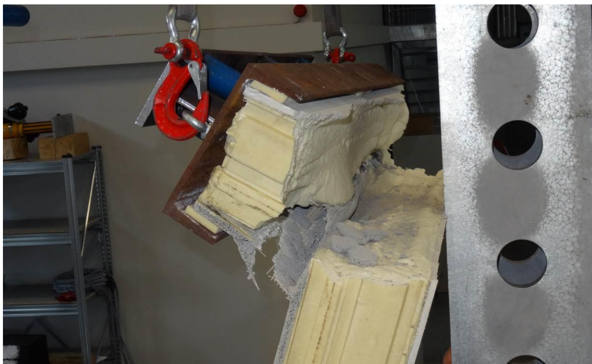
Obr. 19 Detail porušení v horní části vzorku 3.
