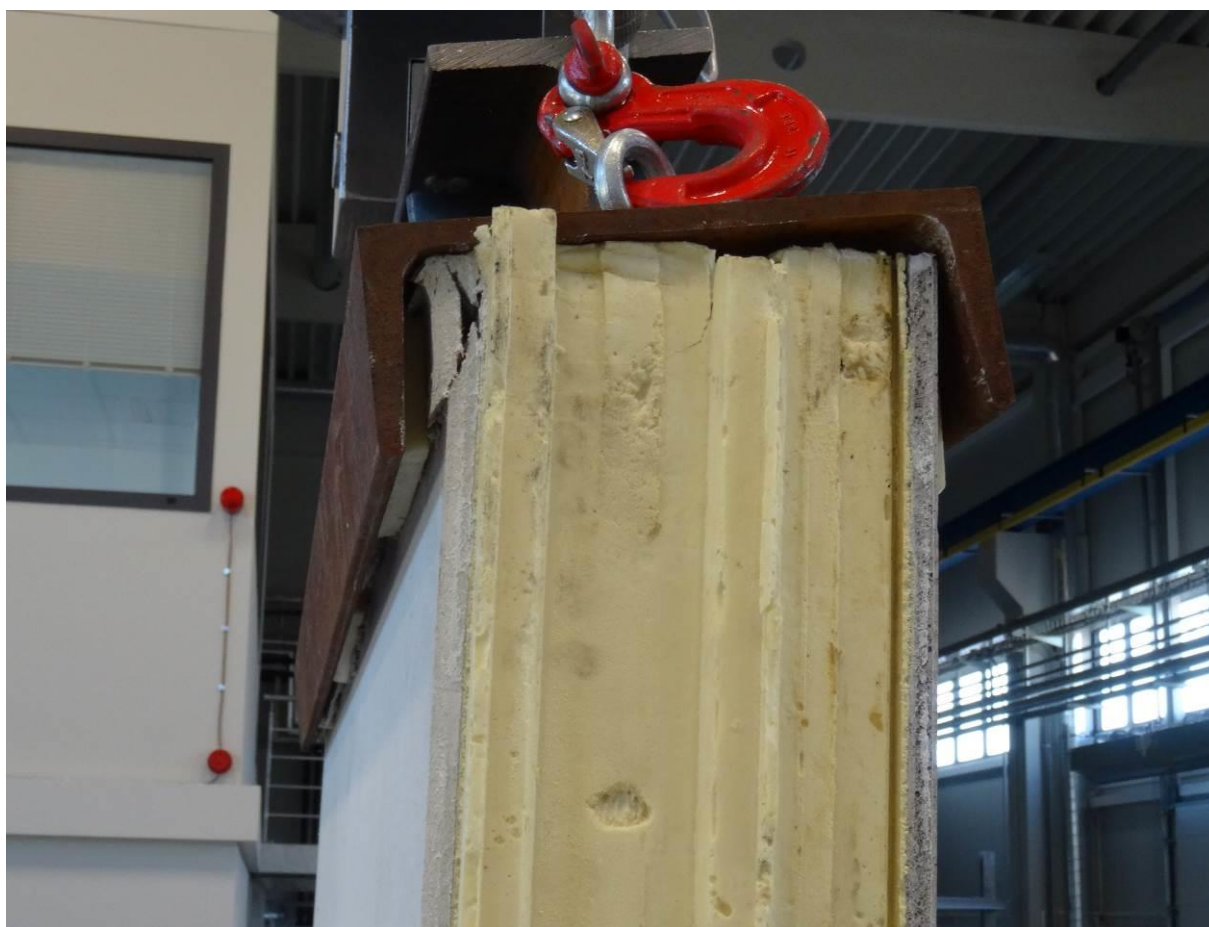
Obr. 9 Porušení smykem v horní části vzorku 1 po skončení testu.
