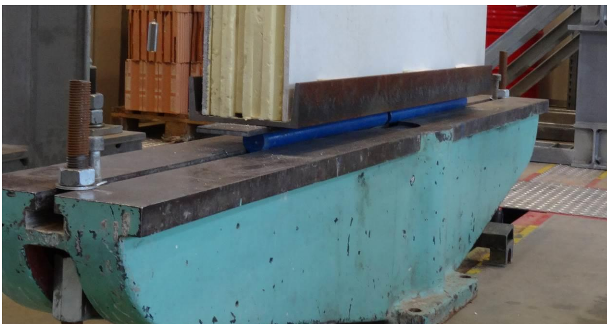
Obr. 4 Detail dolního uložení.
