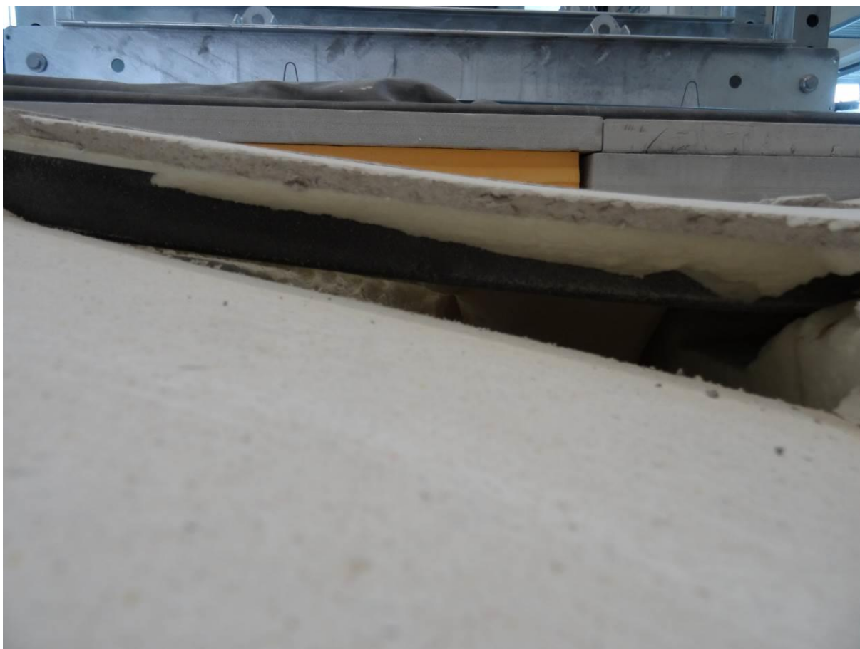
Obr. 15 Vzorek 2 poškozený celoplošným zatěžováním – detail poškození.
