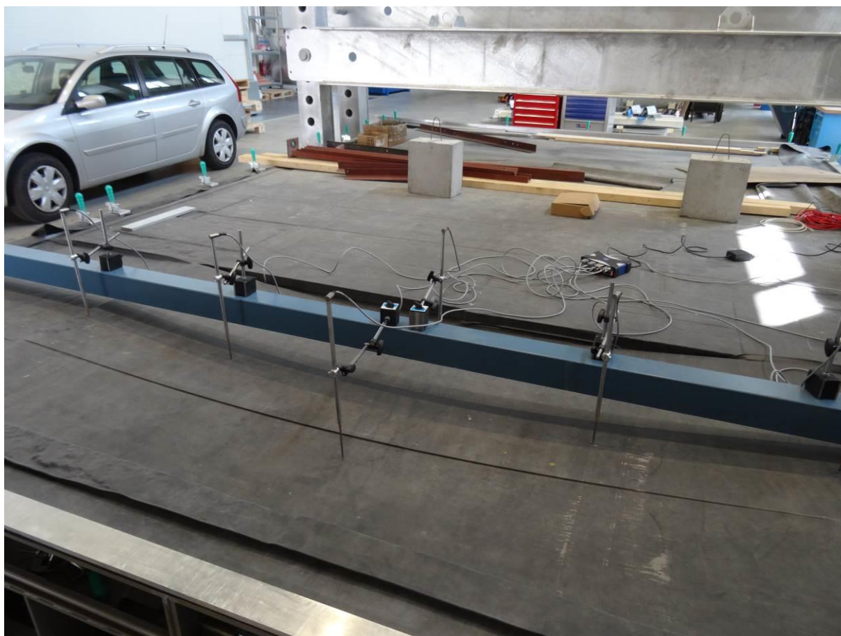
Obr. 5 Detail osazení snímačů pro měření vertikálních deformací v průběhu testu.
