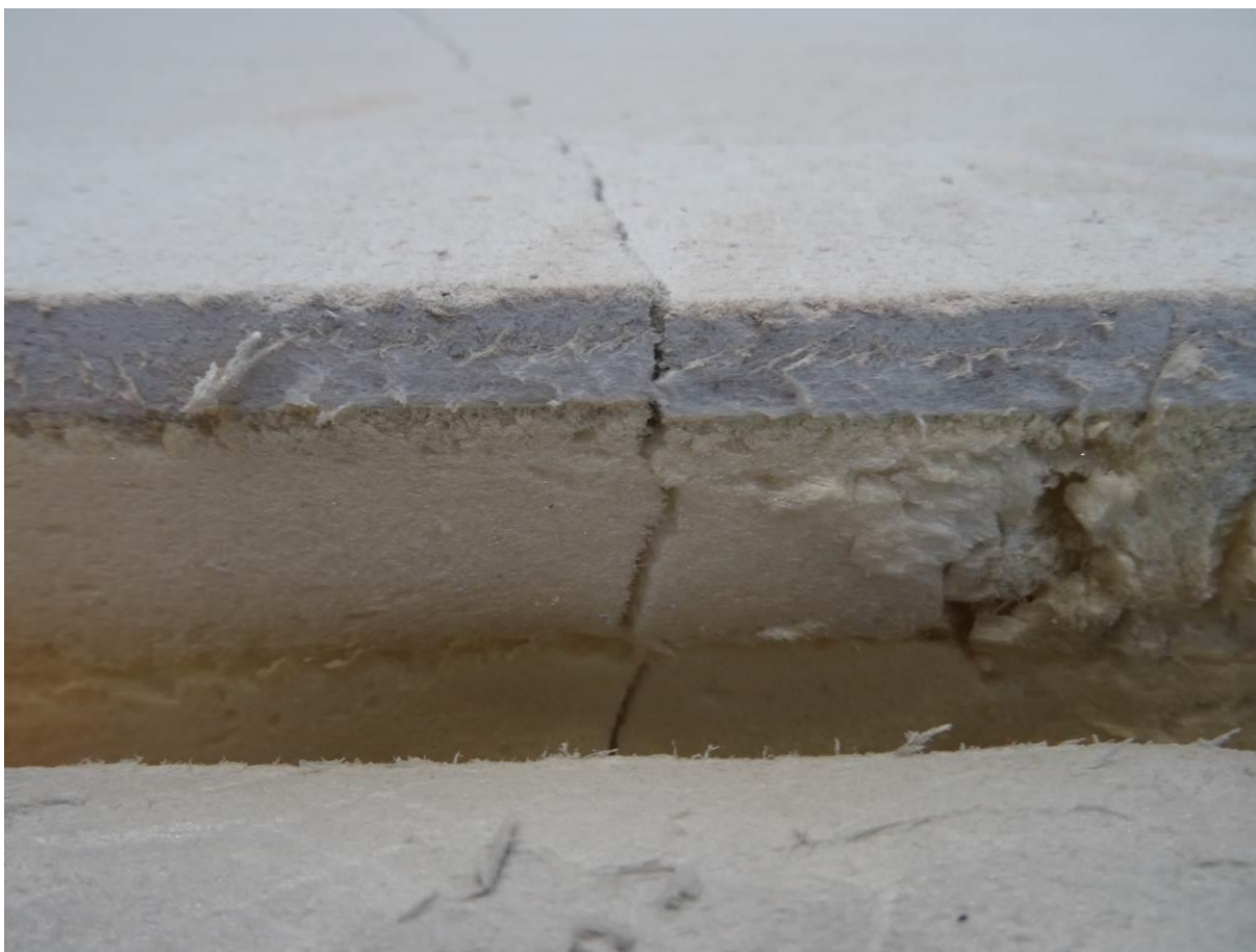
Obr. 16 Vzorek 2 poškozený celoplošným zatěžováním – detail plochy poškození v polovině rozpětí.
