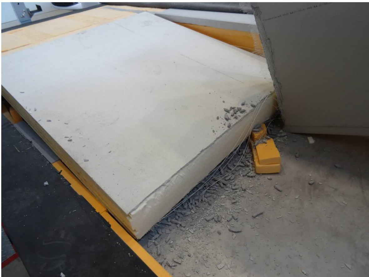
Obr. 8 Vzorek 1 poškozený celoplošným zatěžováním – rozlomen uprostřed rozpětí.
