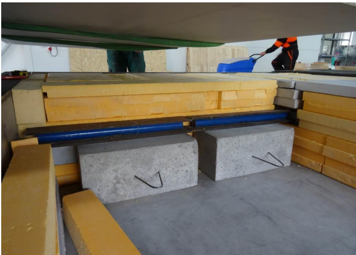
Obr. 4 Detail uložení zkušební vzorku.
