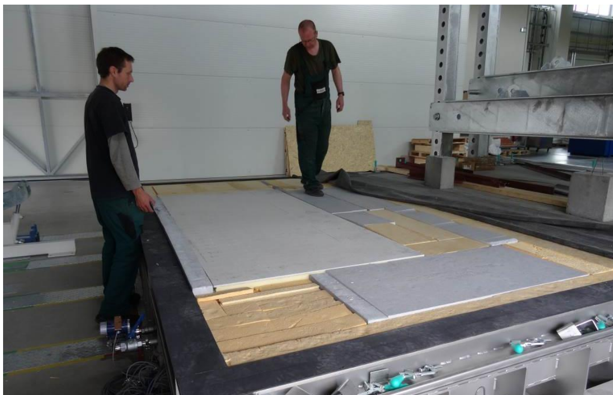
Obr. 2 Sendvičový panel připravený k testu celoplošným zatěžováním
